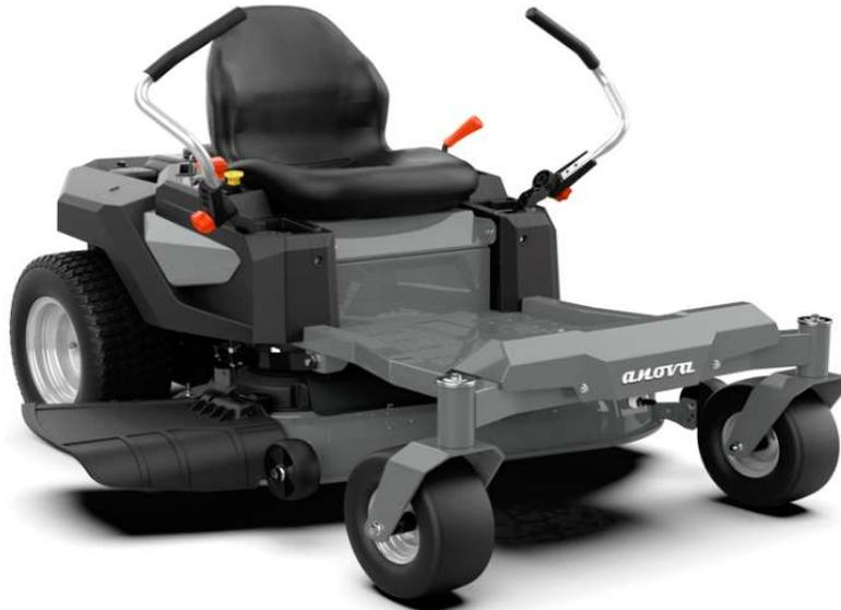
El giro cero Anova ZT107H, significa esencialmente que puede girar sobre sí mismo. La tracción a las ruedas hidráulica e individual permite que el cortacésped de giro cero maniobre de forma precisa y pueda girar sobre su propio eje, sin dejarse atrás el radio de giro y otras zonas sin cortar.
