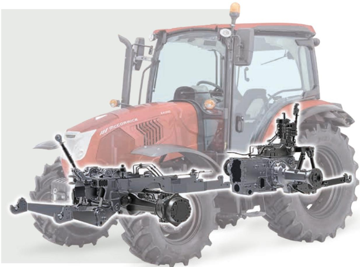
El circuito hidráulico del **X4** cuenta con dos bombas independientes. Una bomba suministra un caudal de 30 l/min al sistema de dirección permitiendo realizar virajes suaves y precisos, incluso durante el trabajo en el campo, para un mayor confort y productividad. La otra bomba tiene un caudal de 52 l/min y garantiza un funcionamiento óptimo de todas las funciones hidráulicas.
