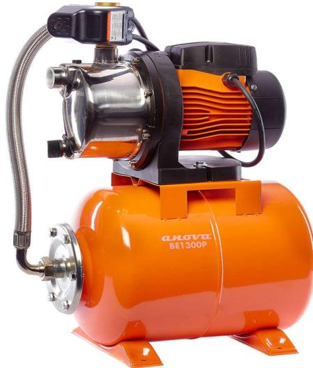
Grupo de presión completo con bomba de 1.300W, diseñado para uso doméstico, listo para conectar y funcionar sin complejos montajes. Cuerpo de bomba en inox. Permite aprovechar y usar fuentes de agua alternativas tales como pozos, depósitos, etc. Rosca de entrada y salida 1". El sistema arranca y para de forma automática según la demanda de agua. Presión de arranque 1.8 bar y presión de corte 3.2 bar.
