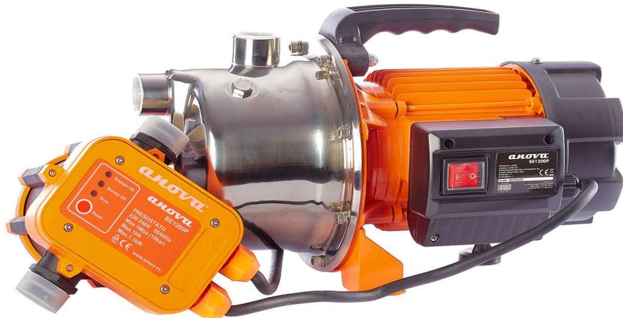
Bomba diseñada como una solución integral para riego en jardines o plantíos. Permite un uso muy flexible gracias a su ligero peso y portabilidad. Cuerpo de la bomba fabricado en Inox. Incluye presscontrol para regular de manera automática la activación y corte de la bomba. Rosca de entrada y salida 1"
