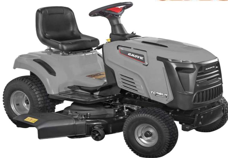
Este tractor cortacésped con salida lateral será la alternativa perfecta para cortar jardines de mayor tamaño de manera eficaz y cómoda. Su motor Loncin de 432cc garantiza la potencia necesaria a la hora de cortar el césped. Tiene una capacidad de corte de hasta 98cm con 7 diferentes posiciones de corte, llegando a una altura de corte de 90mm.
