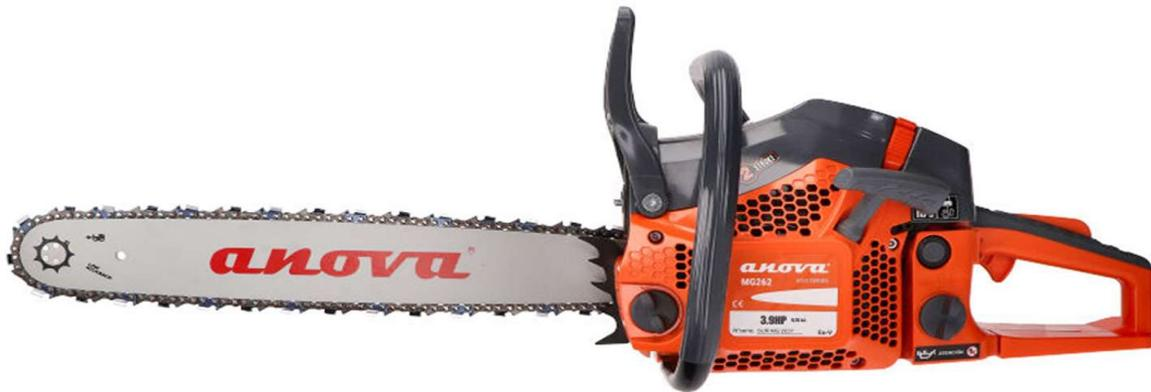
Con la motosierra MG262 conseguirás trabajar adaptándose a diferentes labores forestales. Es un modelo de calidad que permite realizar cada movimiento con una potencia de hasta 2.85 kW y una velocidad de la cadena de 21m/s. Por otro lado, esta motosierra serie ECO posee un carburador tipo diafragma y lleva una mezcla proporción 25:1 (4%).
